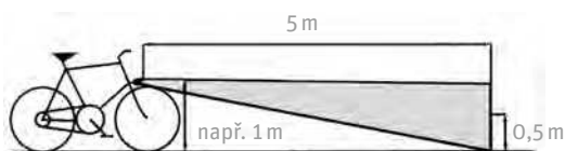
Centrování předního reflektoru
