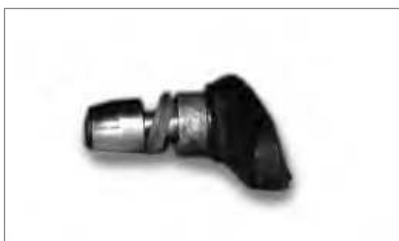
Opotřebované brzdové obložení
